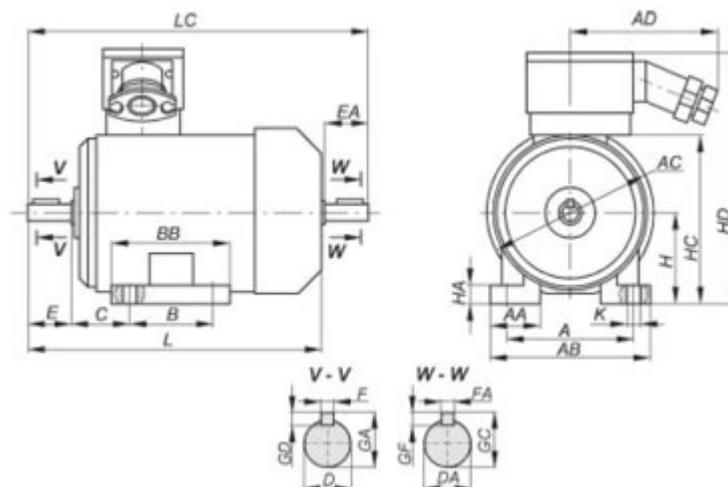
Габаритные, установочные и присоединительные размеры взрывозащищенных двигателей серии ВА. Монтажное исполнение IM 2...1, IM 2...2.
