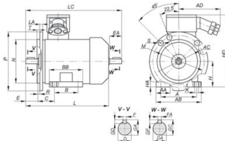
Габаритные, установочные и присоединительные размеры взрывозащищенных двигателей серии ВА. Монтажное исполнение IM 3...1, IM 3...2.
