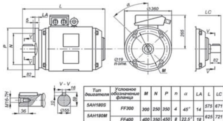
Габаритные, установочные и присоединительные размеры двигателя 5AH200S...НЛБ. Монтажное исполнение IM 3001, IM 3002.
