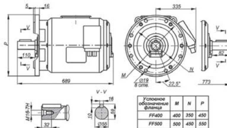
Габаритные, установочные и присоединительные размеры двигателя 5АФ200М...НЛБ. Монтажное исполнение IM 3001, IM 3002.
