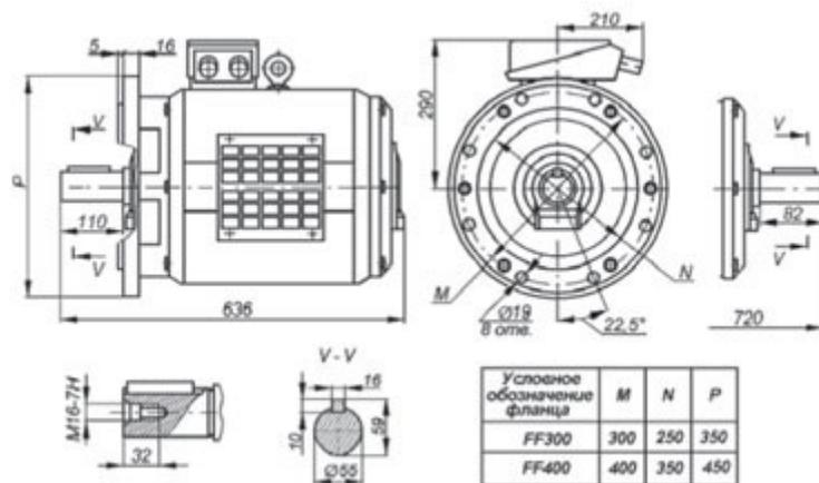
Габаритные, установочные и присоединительные размеры двигателя 5АН200М...НЛБ. Монтажное исполнение IM 3001, IM 3002
