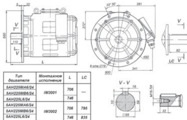
Габаритные, установочные и присоединительные размеры двигателя 5АФ225...НЛБ. Монтажное исполнение IM 3001, IM 3002.
