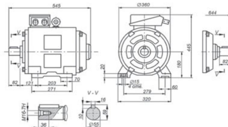
Габаритные, установочные и присоединительные размеры двигателя для привода лифтов габарита 180 мм. Монтажное исполнение IM 3001, IM 3002.
