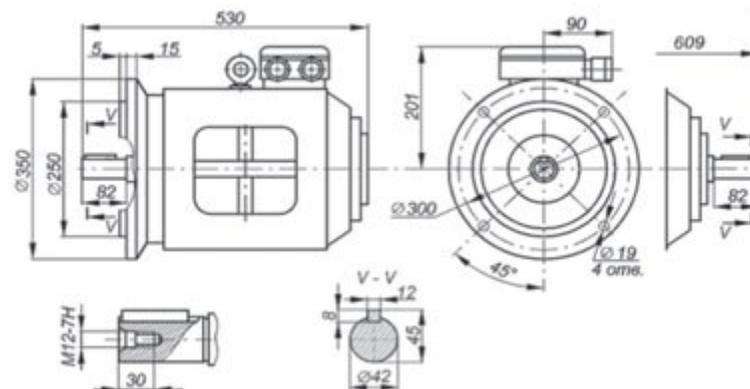
Габаритные, установочные и присоединительные размеры двигателей 5АН180S6/24НЛБ. Монтажное исполнение IM 1001, IM 1002.
